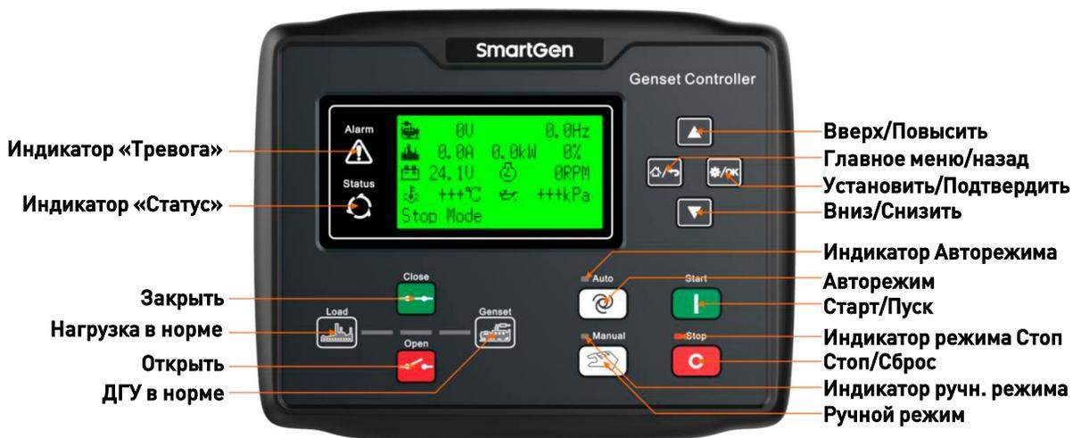
Рис.1 – Лицевая панель HGM6110 (HGM6110N/NC/CAN)
